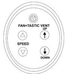
Attic Fan Control
